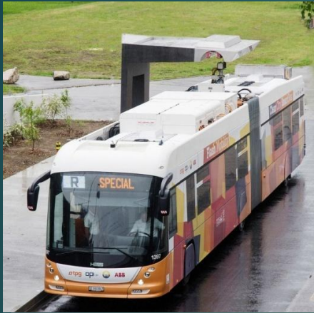
ABB TOSA rendszer Genfben
