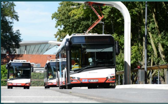
Szabványosított Siemens elektromos busz töltő
